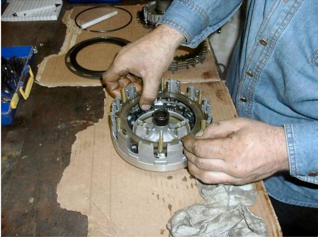
Quindi applicare 2 rondelle piane dalle seguenti misure: diametro esterno 6,5 mm. diametro interno 4 mm. spessore 0,7 mm. , in ogni guida molla (foto sotto):
