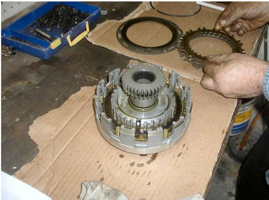
Qui sotto la campana priva di tutti i dischi e del mozzo frizione, con in evidenza la serie di massette che, azionate dalla forza centrifuga (esattamente come nel variatore) permettono l'attacco o lo stacco della frizione che normalmente avviene a circa 1.800 giri/min.:
