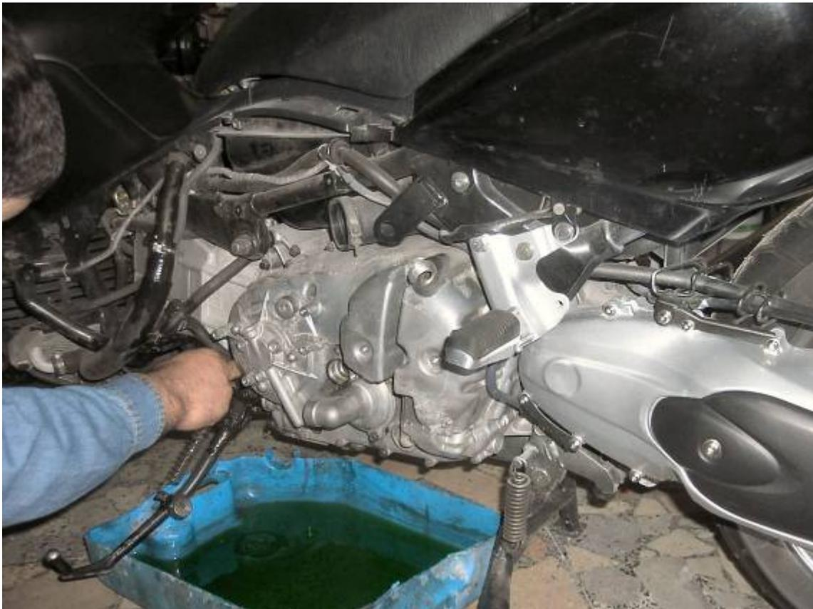
Passiamo ora alla rimozione dei 19 bulloni da M6 con la chiave a T da 10 che fissano il carter frizione e quindi, avvalendoci di un martello in plastica andiamo a battere sul carter stesso, sino a che la guarnizione non si “scollì” dalla sua sede permettendo appunto il distacco del carter stesso (foto sotto):
