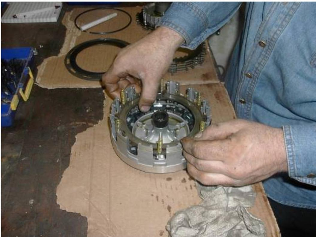
Una volta sistemati tutti i dischi sul mozzo frizione posizionare la piastra reggispinta e rimettere il seeger nel suo alloggiamento procedendo come per lo smontaggio:
