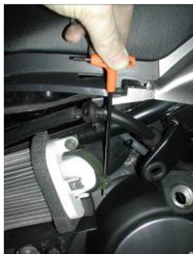
Rimuovere il tappo di carico dell'olio motore e le due viti sul carter logato YAMAHA indicate dalla freccia e toglierlo unitamente alla protezione in plastica nera sottostante (foto sotto):
