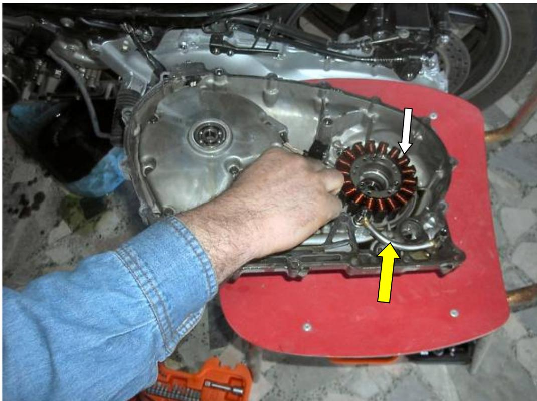
Ecco nella foto sotto, finalmente aperto, l'interno del carter frizione con la stessa sulla parte DX indicata dalla freccia. Si notino l'ingranaggio di rinvio del motorino d'avviamento **1**, il comando a catena della pompa dell'olio **2** e il rotore dell'accensione **3** ;
