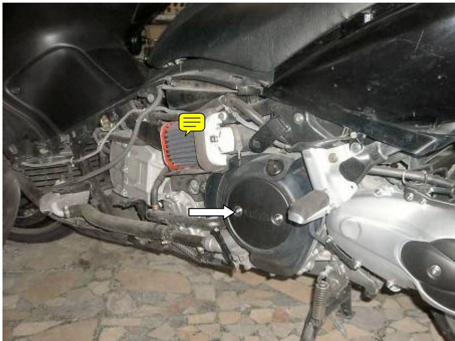
A questo punto scaricare il liquido refrigerante rimuovendo il manicotto indicato dalla freccia verde ed il manicotto passaggio olio indicato dalle frecce gialle. **NOTA: Sostituire obbligatoriamente gli O-RING di tenuta di tutti i manicotti (sono solo 5 e costano una sciocchezza)**
